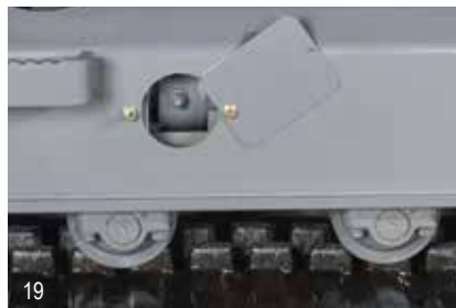
PEŁNAUTOMATYCZNY HYDRAULICZNY UKŁAD NAPINANIA GĄSIENIC
