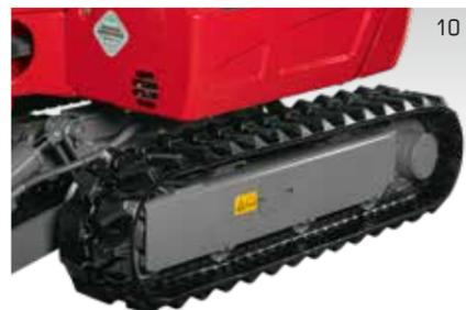
Die ausgezeichnete Qualität des hydraulischen und stufenlosen Teleskoplaufwerks zahlt sich in verschiedener Hinsicht aus:
